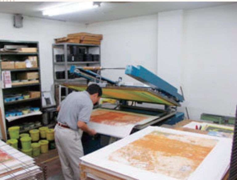
シルクスクリーンプリントの様子 View of silkscreen printing
